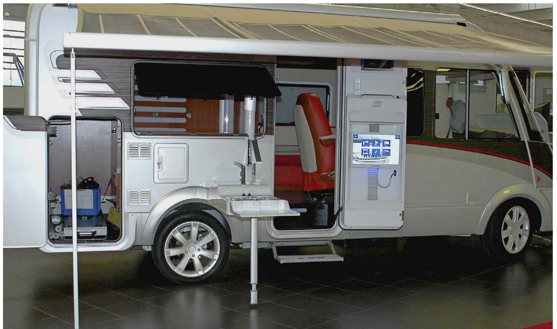
Eine Markise, deren Oberfläche mit flexiblen Solarpaneelen beschichtet ist, zählt zur ökologisch sinnvollen Ausstattung des Wohnmobil-Prototypen »Innovation«.
